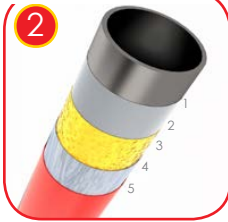
2 Massive Konstruktion aus schwarzem Stahl S235JR, gereinigt im Sandstrahlverfahren. Korrosionsschutz durch Verzinkung und Pulverlackierung mit Polyesterlacken, UV-beständig, mit QUALICOAT-Zulassung .
