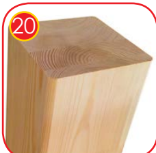
20 Nadelholz , Querschnitt 140x140 mm, Kern- und ästelos, mit Polyurethan-Klebstoffen einlagig verklebt, völlig wasserfest. Druckimprägnierte, zusätzlich mit einer Wachsimprägnierungsschicht überzogen.
