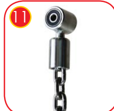
11 Doppelt gelagerte Edelstahlschlingen sorgen für einen leisen Betrieb. Zusätzlich zum Schwenken der horizontalen Achse, dreht es sich auch um die vertikale Achse um ein Verdrehen der Kette zu verhindern. Die Schlingen sind komplett aus Edelstahl gefertigt.
