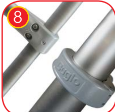
8 Patentiertes System von Verbindern und Klemmen aus starken Aluminiumlegierungen. Die Schnallen sind mit einem Scharnier ausgestattet, das eine hohe Steifigkeit der Struktur und eine einfache Montage durch Verschrauben mit einer einzigen Schraube gewährleistet. Das Aluminium ist im Kataphorese-Prozess gegen Korrosion geschützt und pulverbeschichtet mit Polyesterlacken, UV-beständig und von QUALICOAT zertifiziert.
