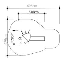
**BENÖTIGTER FALLSCHUTZ AUFGRUND DER FALLHÖHE**Die PN-EN 1176-1: 2009 ermöglicht die Abfederung des Sturzes durch folgende Oberflächen:
